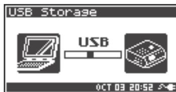
Der Computer erkennt den R-44, und der rechts abgebildete Bildschirm wird angezeigt. Die Erkennung kann einige Sekunden dauern.
