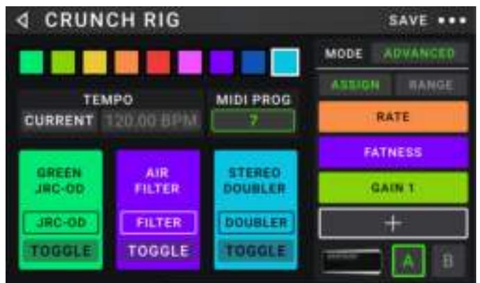
Um dem **Rig eine Farbe zuzuordnen**, drückst Du das betreffende Feld oben links. Die gewählte Farbe wird neben dem Rig-Namen angezeigt, wenn man eine Rig-Übersicht aufruft bzw. die Setlisten editiert oder sie sich einfach nur anschaut. Auf der Rig-Funktionsebene des HeadRush MX5 verwendet die LED des zugeordneten Fußtasters diese Farbe ebenfalls.
