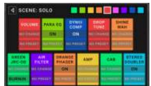
Um eine **Scene** umzubenennen (die in den Fußschalteranzeigen angezeigt wird), tippen Sie auf dem Modell auf den Text im Feld unter **Edit**, verwenden die angezeigte virtuelle Tastatur, um einen Namen einzugeben und tippen dann auf eine andere Stelle als das Textfeld.
