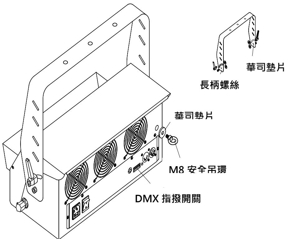
請將機器安裝於通風處，不要堵住機器出口，並確認至少預留 20 公分的空間以利空氣流通。若需裝置在公眾場合，請先考慮泡泡液可能會造成地面濕滑，而發生危險。盡量在遠離人群的位置安裝機器，至少預留 1.5 公尺的距離，並確認機器安裝在防滑且防水的地方。
