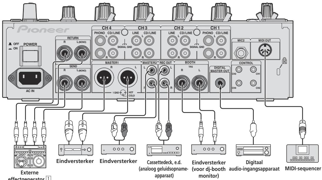
1 Sluit tevens een externe effectgenerator aan op de [RETURN]-aansluiting (ingangsaansluiting).
