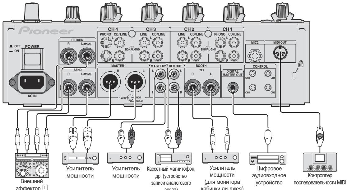
1 Также, подключите внешний эффектор к терминалу **[RETURN]** (входной терминал).
